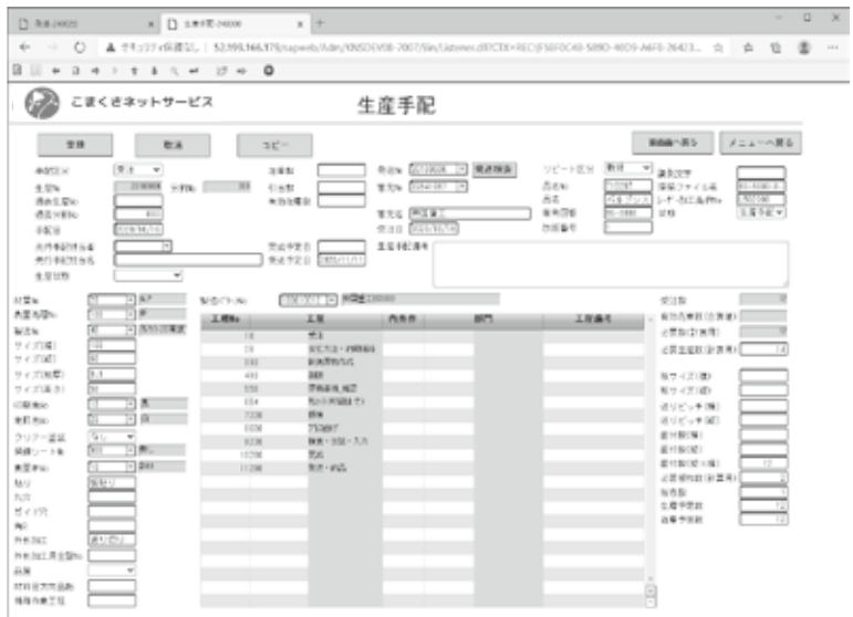
図5 ローコード開発ツール(Sapiens)で開発した工程管理システムの例
